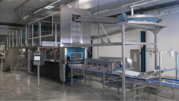
L'Hygro Control System est une solution en instance de brevet qui minimise l'entrée d'air frais. Ce système permet un pilotage automatique de l'hygrométrie, garantissant à la fois l'efficacité énergétique et la qualité des produits.
